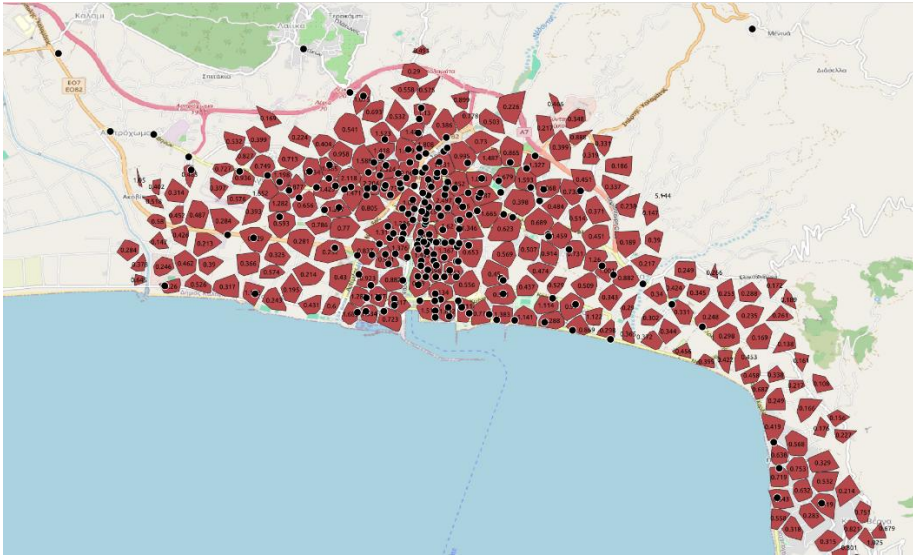
Σχήμα 40: Αποτελέσματα clustering k-means και θέσεις καμπινών χαλκού (μαύρα σημεία)
