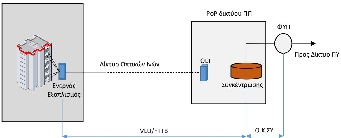
Κάθε κόμβος Ethernet Aggregation συγκεντρώνει κίνηση από έναν αριθμό κτιρίων μέσω ενός εκτεταμένου Δικτύου Οπτικών Ινών. Η σύνδεση μεταξύ του ενεργού εξοπλισμού κάθε κτιρίου και του κόμβου τερματισμού του οπτικού δικτύου (Optical Line Termination - OLT) γίνεται μέσω κατάλληλων οπτικών συνδέσεων. Εν συνεχεία κάθε κόμβος OLT συνδέεται μέσω επαρκών οπτικών διεπαφών με τον Κόμβο Συγκέντρωσης ο οποίος βρίσκεται στο PoP του ΠΠ.
