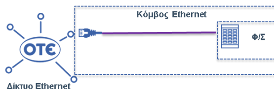
Εικόνα 6: Σχηματική απεικόνιση πρόσβασης Ethernet από Φυσική Συνεγκατάσταση
