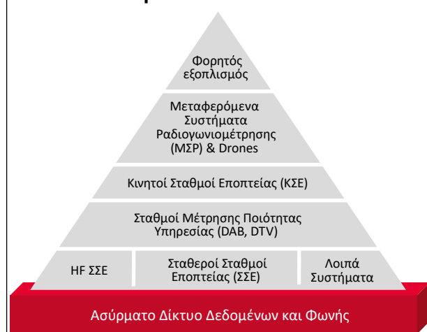
Σχήμα 1: Ολοκληρωμένο εθνικό-επίγειο και δορυφορικό-σύστημα εποπτείας φάσματος ραδιοσυχνοτήτων
