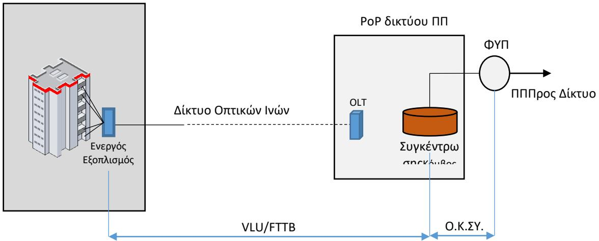
Κάθε κόμβος Ethernet Aggregation συγκεντρώνει κίνηση από έναν αριθμό κτιρίων μέσω ενός εκτεταμένου Δικτύου Οπτικών Ινών. Η σύνδεση μεταξύ του ενεργού εξοπλισμού κάθε κτίριου και του κόμβου τερματισμού του οπτικού δικτύου (Optical Line Termination - OLT) γίνεται μέσω κατάλληλων οπτικών συνδέσεων. Εν συνεχεία κάθε κόμβος OLT συνδέεται μέσω επαρκών οπτικών διεπαφών με τον Κόμβο Συγκέντρωσης ο οποίος βρίσκεται στο RoP του ΠΠ.
