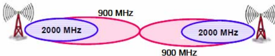
Σχήμα 10. το UMTS900 προσφέρει συνεχόμενη κάλυψη, το UMTS2000 χρησιμοποιείται για να προσφέρει επιπλέον κάλυψη σε hot spots
