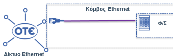
Εικόνα 6: Σχηματική απεικόνιση πρόσβασης Ethernet από Φυσική Συνεγκατάσταση
