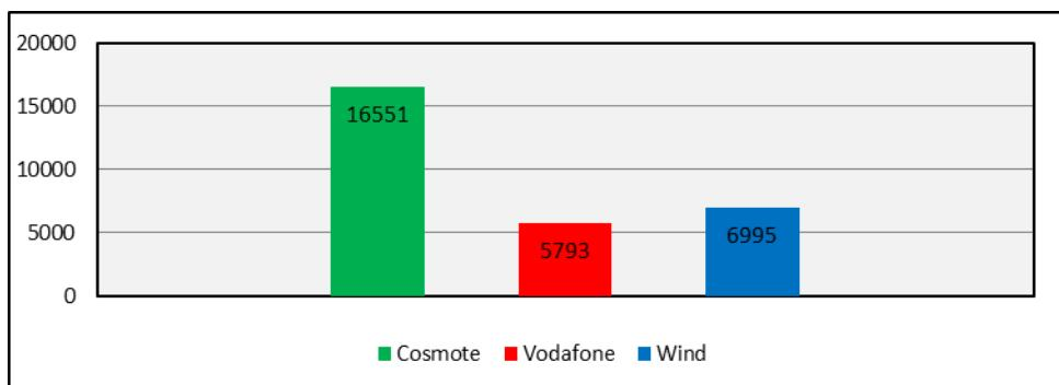
Εικόνα 11-2: Μέσος ρυθμός μεταφοράς δεδομένων ftp upload (Kbps)
