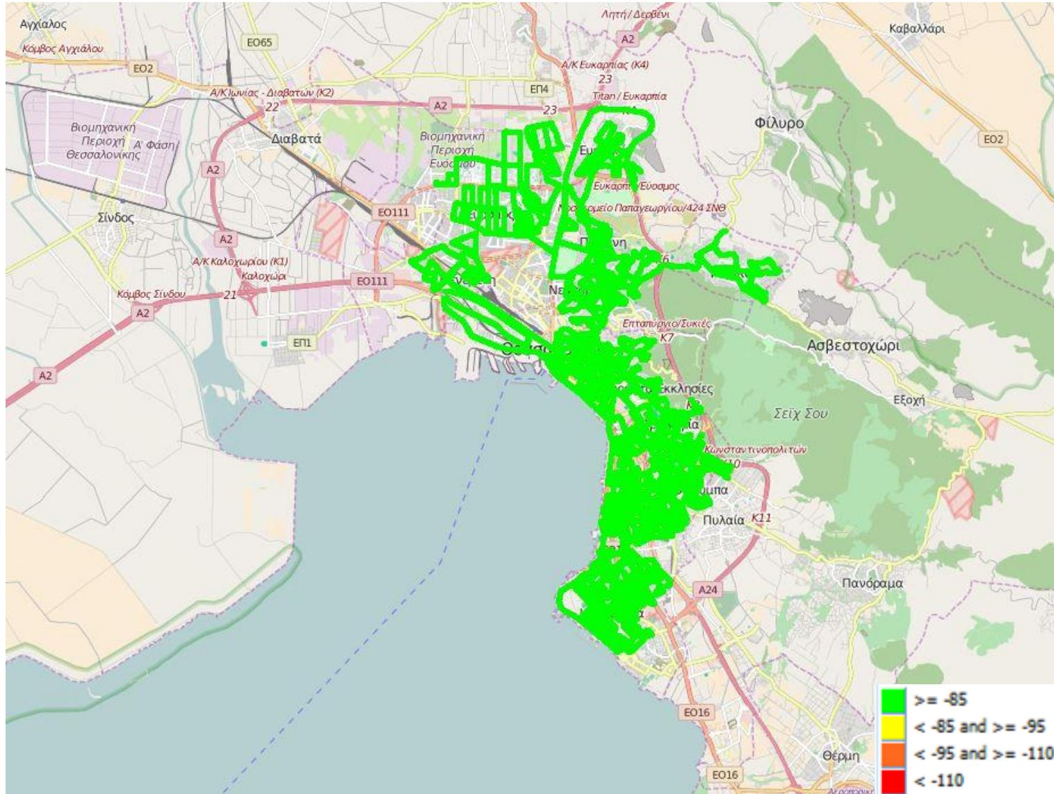
Εικόνα 13-3: Ραδιοκάλυψη WIND – GSM
