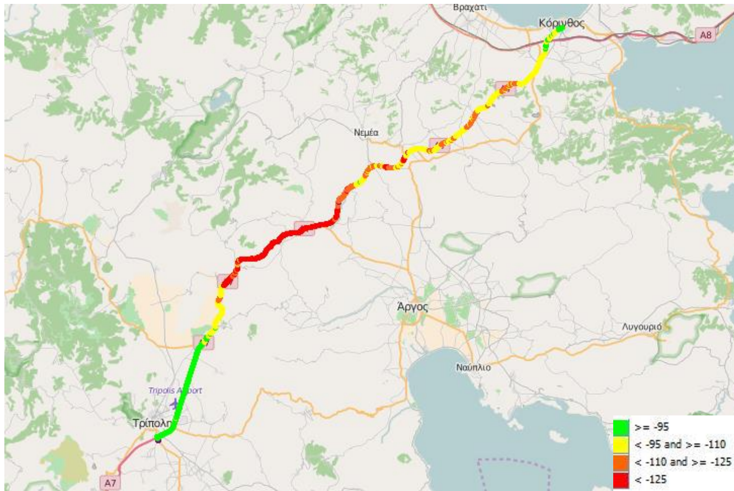
Εικόνα 13-8: Ραδιοκάλυψη Vodafone – LTE
