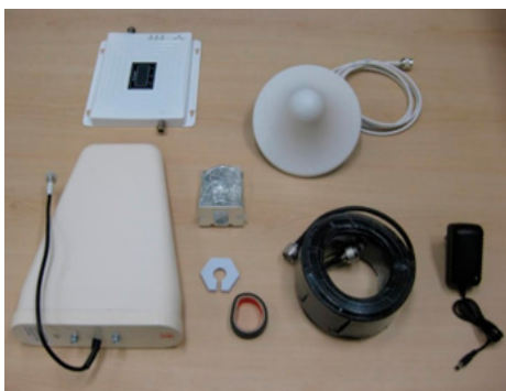
Φωτογραφία 1: Ενισχυτής σήματος κινητής τηλεφωνίας (GSM Repeater) με εμπορική ονομασία LINTRATEK KW20C-GDW
