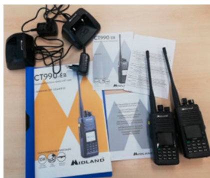
Φωτογραφία 2: Ασύρματος πομποδέκτης (PMR transceiver) με εμπορική ονομασία MIDLAND CT990-EB
