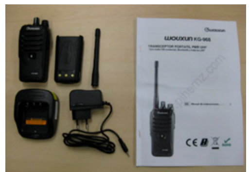
Φωτογραφία 3: Ασύρματος πομποδέκτης (PMR transceiver) με εμπορική ονομασία WOUXUN KG-968
